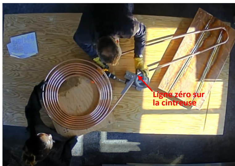
Figure 16 : Cintrreuse de tube sur le tuyau de cuivre au début de la deuxième courbure
