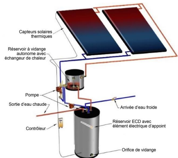
Figure 1 : Système solaire thermique à vidange autonome
