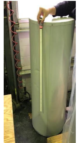
Figure 79 : Mesurer la mi-hauteur du réservoir
