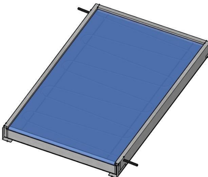
Figure 3 : Capteur solaire thermique terminé et assemblé
