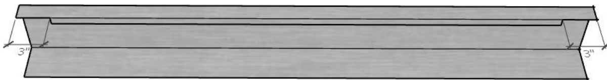
Figure 61 : Découpe des extrémités du solin supérieur
